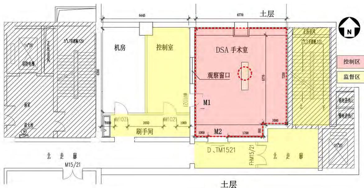
图 11-4 本项目拟建 DSA 机房布局和分区示意图
